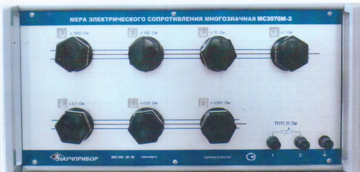
Рисунок 2 - Фотография общего вида мер электрического сопротивления постоянного тока многозначных МС 3070М-2
