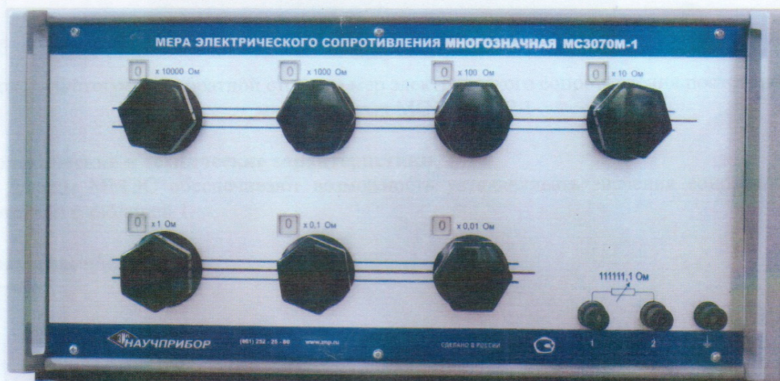
Рисунок 1 - Фотография общего вида мер электрического сопротивления постоянного тока многозначных МС 3070М-1
